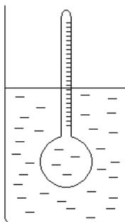
Como se pode notar, contém um bulbo meticulosamente calibrado e uma escala...
